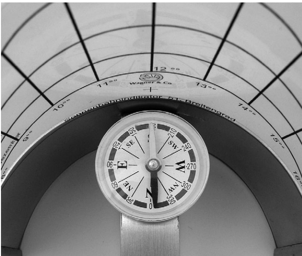
Abb. 4 Den Sonnenbahnindikator mit dem Kompass nach Süden ausrichten und dabei möglichst waagrecht halten.
